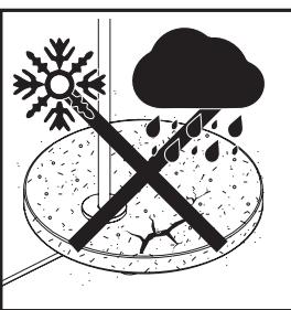
**IT.** Durante il montaggio e la manutenzione degli apparecchi è necessario prestare particolare attenzione a non danneggiare la verniciatura a polvere. Un danno combinato all'azione dell'acqua potrebbe provocare la corrosione. I prodotti chimici danneggiano la protezione anticorrosione.
